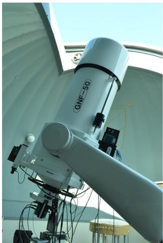
51cm反射式望遠鏡とCCDカメラ
